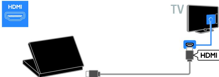
Подключите компьютер к телевизору с помощью кабеля DVI-HDMI и аудиокабеля.
