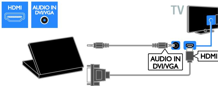
Подключите компьютер к телевизору с помощью кабеля VGA и аудиокабеля.
